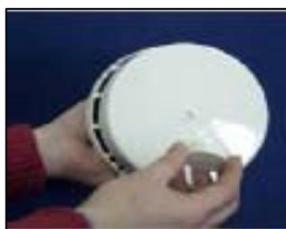
В соответствии с аэродинамическими характеристиками производительность клапана зависит от создаваемого вытяжкой разряжения: при разряжении 20 Па (создает механическая вытяжка) -  $50 \text{ м}^3/\text{ч}$ ; при разряжении 10 Па (создает естественная вытяжка) -  $35 \text{ м}^3/\text{ч}$ .
